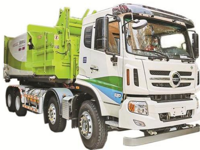
即将投入使用的深圳开沃牌 LNG 垃圾转运车
