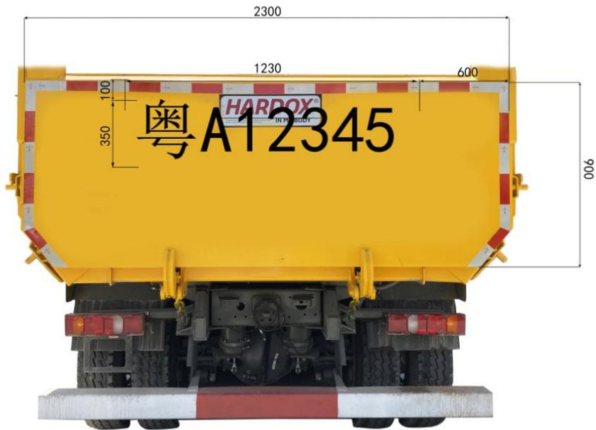
图 B.6 四轴燃油自卸货车后尾门外观样式
