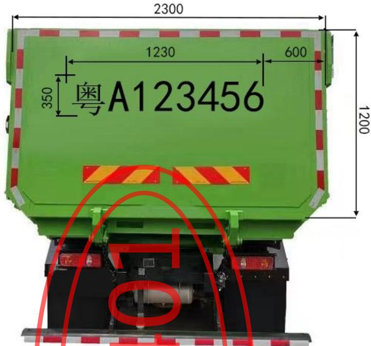
图 B.12 四轴燃料电池电动自卸货车后尾门外观样式
