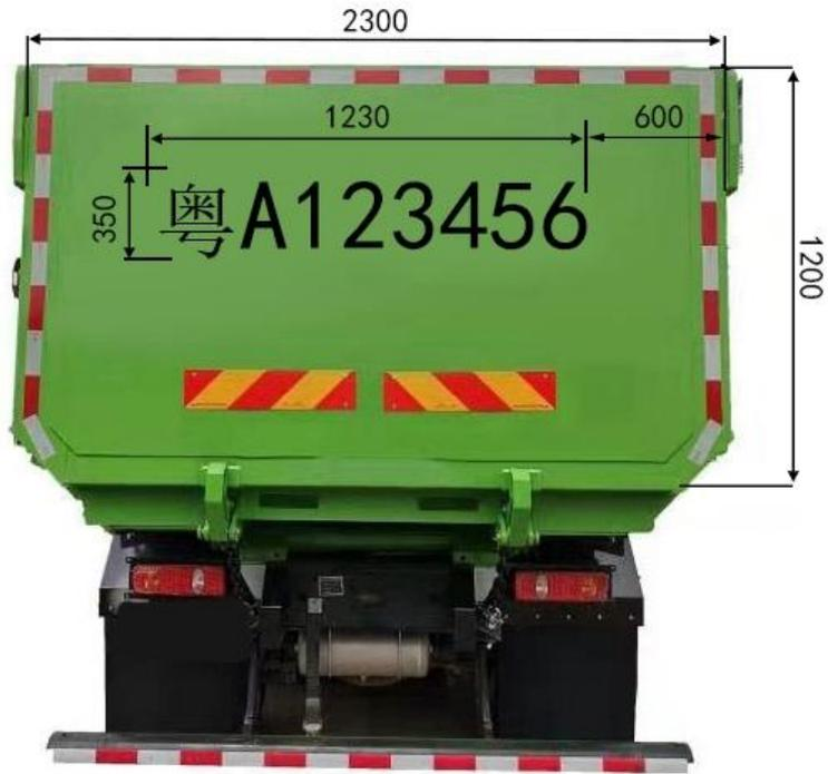
图 B.18 四轴纯电动自卸货车后尾门外观样式
