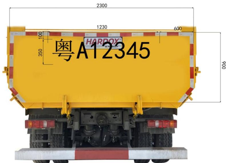
图 B.3 三轴燃油自卸货车后尾门外观样式
