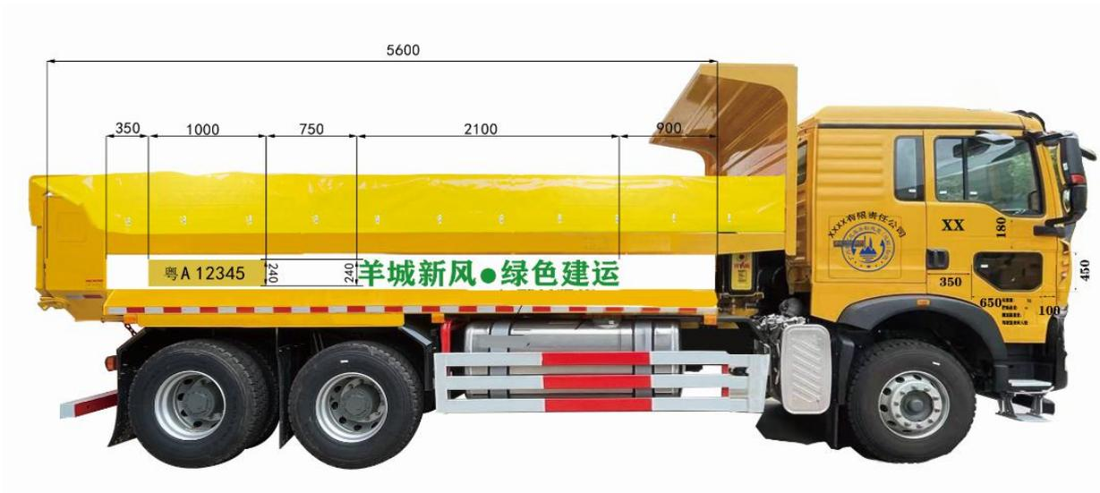
图 B.2 三轴燃油自卸货车右侧车身外观样式
