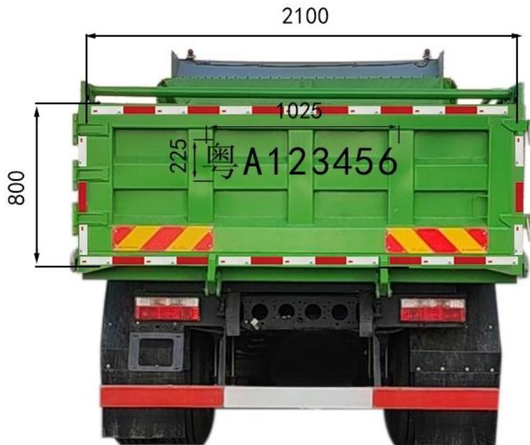
图 B.15 二轴纯电动自卸货车后尾门外观样式
