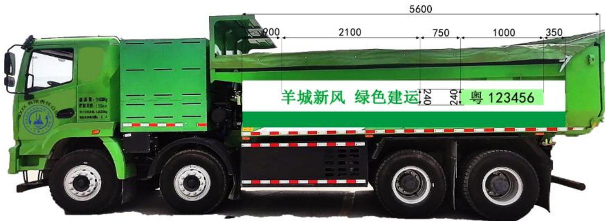
图 B. 10 四轴燃料电池电动自卸货车左侧车身外观样式
