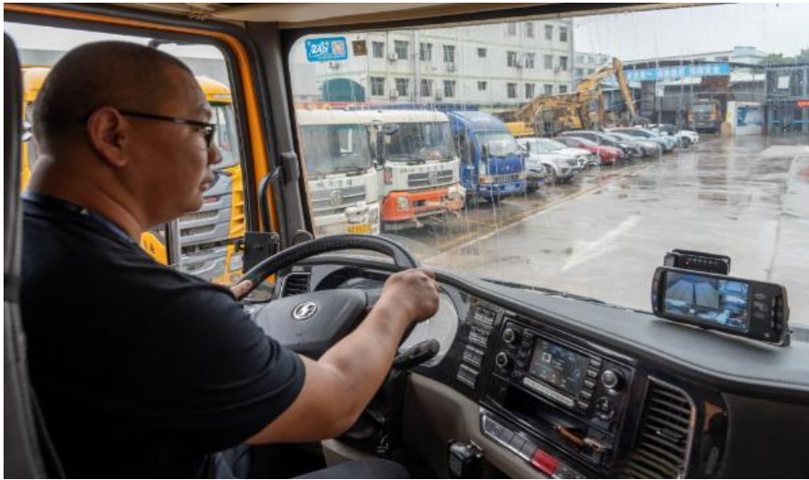
驾驶室安装建废车辆右侧盲区智能监测系统显示屏
