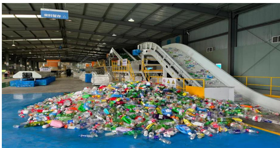
海曙区可回收物分拣中心混合塑料分选线
