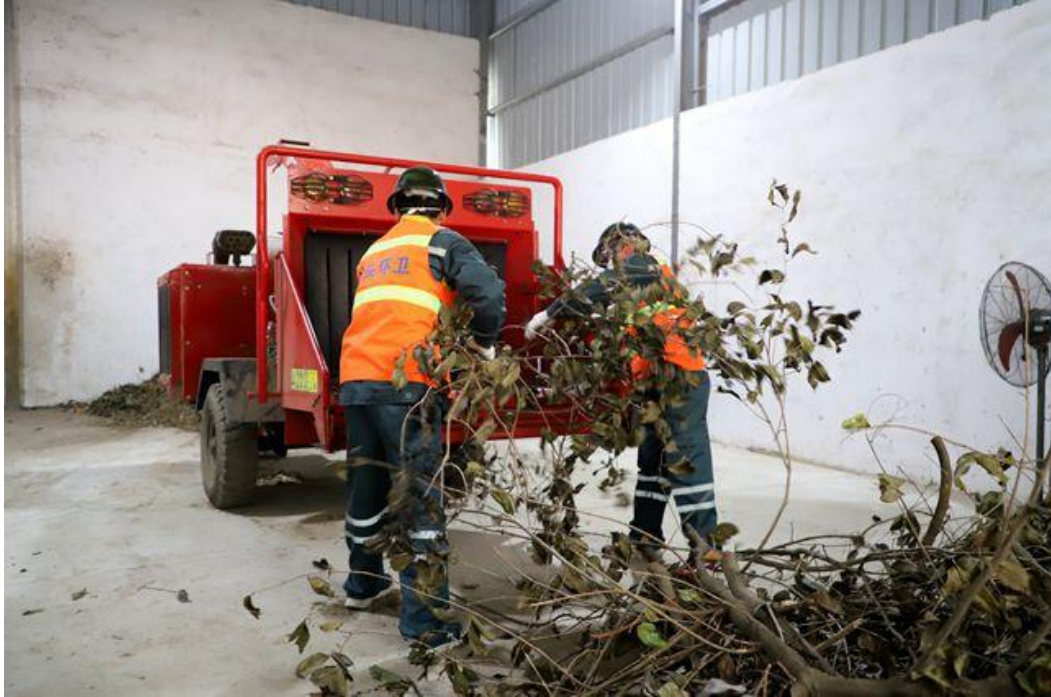
绿化垃圾处理站，将绿化垃圾分裂
